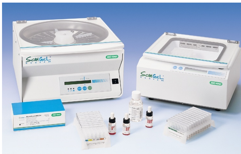
Рисунок 2.1 - Оборудование для проведения иммуногематологических исследований гелевым методом (центрифуга, инкубатор, диагностические карты, цоликлоны, стандартные эритроциты)
